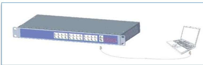
Перед подключением кабеля электропитания следует убедиться, что его параметры соответствуют заявленным в спецификации устройства. После подключения кабеля электропитания к коммутатору и розетке должен загореться индикатор питания.
