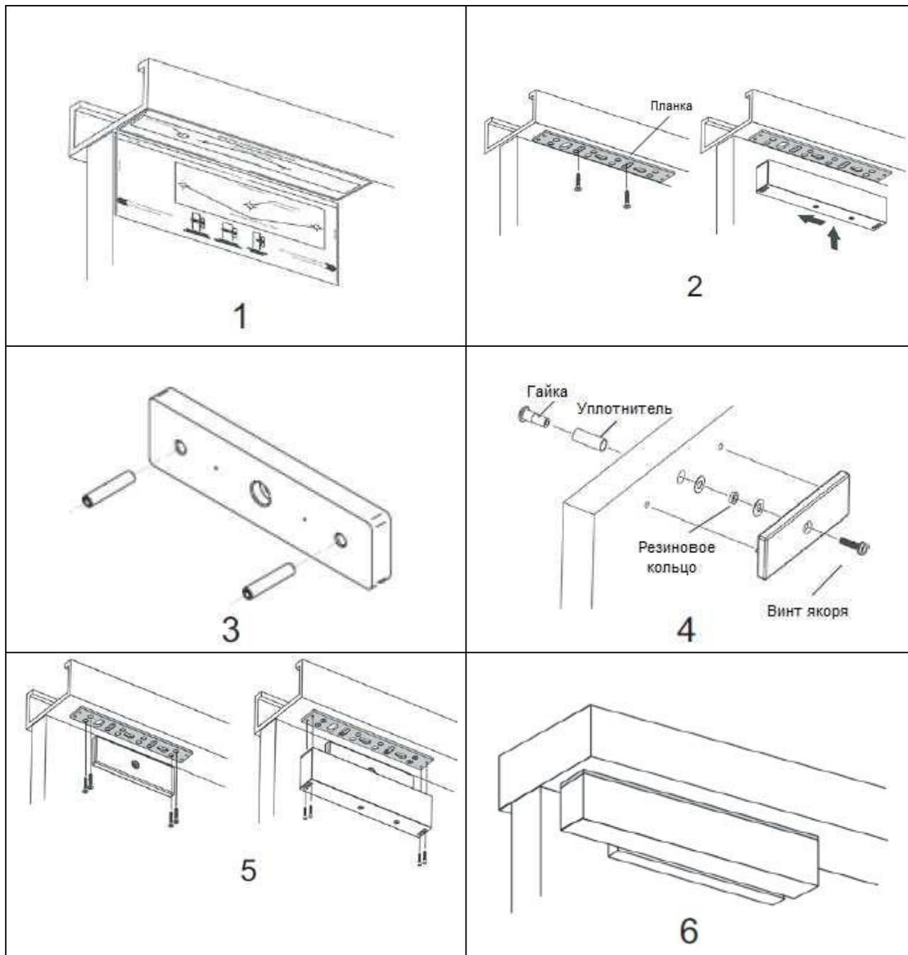
1. Используйте прилагаемый шаблон, чтобы определить правильное расположение и размер крепежных отверстий, как для двери, так и для рамы. Убедитесь, что дверь открывается в направлении от магнитного замка. В случае одинарной двери
